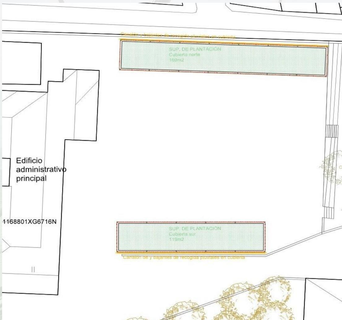
La actuación consiste en la construcción de dos cubiertas vegetadas extensivas en una zona de aparcamiento en superficie, ejecutadas mediante estructura metálica y forjado de chapa colaborante, con sistema de recuperación de aguas pluviales, almacenaje en depósito enterrado y reutilización en sistema de riego.
